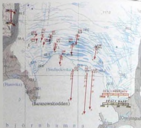
Rys. 11. Graficzne wyniki pomiaru ruchu powierzchniowego strefy czołowej lodowca Hans, mierzonego w interwałach jednodniowych (pozycje A, B, C i D) od 16 do 19 sierpnia 1984 roku. Cały wektor (pozycja E) ilustruje ruch strefy czołowej w okresie 12 dni (do 28 sierpnia). Wykorzystano mapę podkładową - fragment autorskiego opracowania topograficznego HANS GLACIER [U. Śl., 1994], która przedstawia stan lodowca z roku 1990. Z tego powodu wektory ruchu z roku 1984 znalazły się poza zasięgiem lodowca w 1990 roku.
