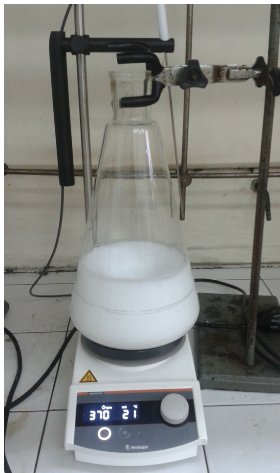
Zdjęcie 1. Mieszanina reakcyjna: 1500 mL roztworu bezwodnego metanolu z 528 mL 25% wag. roztworu amoniaku oraz 100 mL ortokrzemianu tetraetylu.
