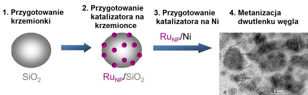
Rys. 10. Schemat przedstawiający proces przygotowania katalizatora reakcji metanizacji CO 2 150 .
