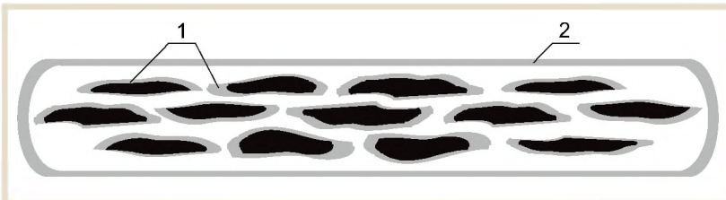
Rys. 5. Schemat wielowłóknowej taśmy otrzymanej techniką PIT, gdzie: 1 – końcowa postać mikrotaśm MgB_2 , 2 – metalowa rurka, np. z Fe
