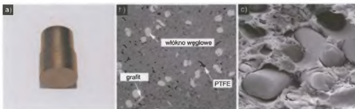
Rys. 4.1. Tworzywo PEEK + 10% PTFE + 10% grafitu + 10% włókien węglowych: a - trzpień przeznaczony do badań tribologicznych, b - przekrój poprzeczny [124], c - przełom [124]
