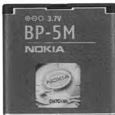
Zdjęcie 1. Bateria litowo - polimerowa BP - 5M o pojemności 900 mAh (miliamperogodzin).
