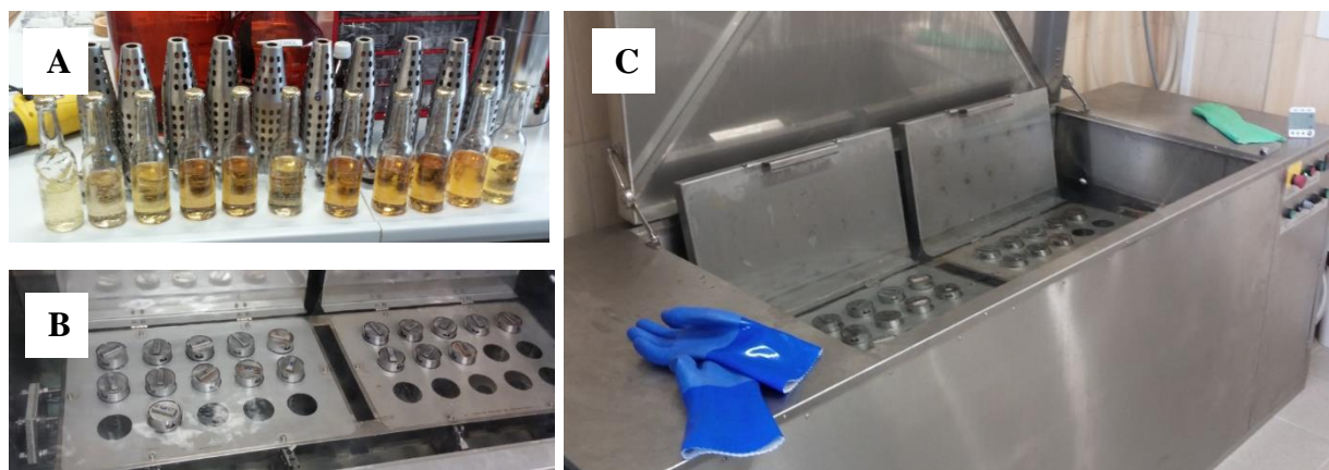
Rysunek 64 Zdjęcia przedstawiające zakapslowane butelki wypełnione roztworem żyjącego polimeru (A), komorę rotacyjną (B) oraz polimeryzator butelkowy (C)
